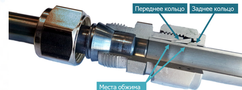
Рис. 2. Обжимной фитинг в разрезе
